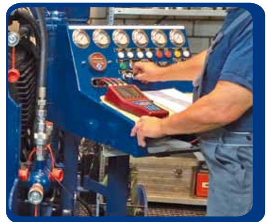
Steuerpult Prüfstand 1 inkl. digitaler Auswertung der Prüfdaten
