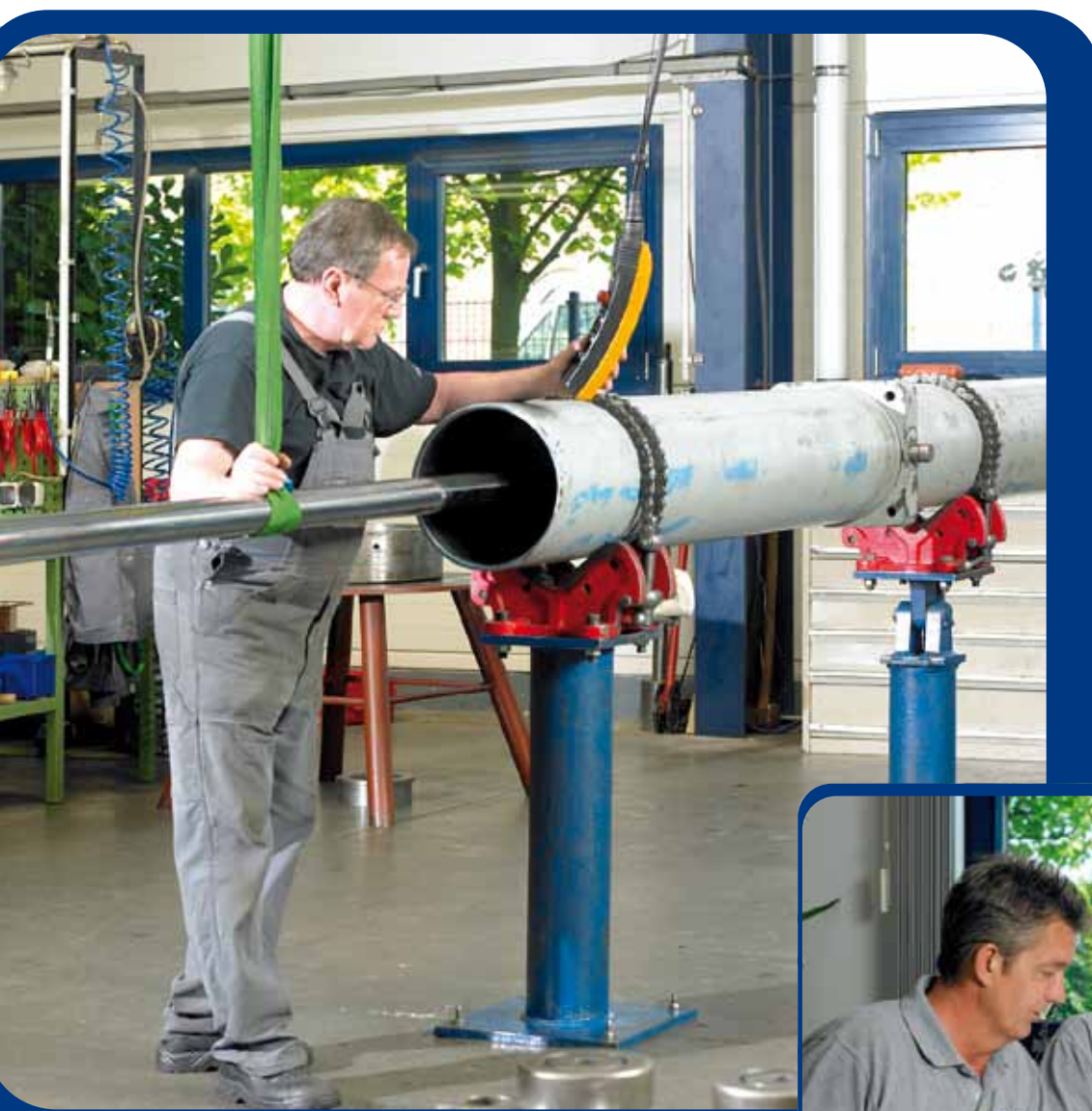
Demontage eines doppelwirkenden Zylinders an speziell angefertigten Ketten-Schraubstöcken.
